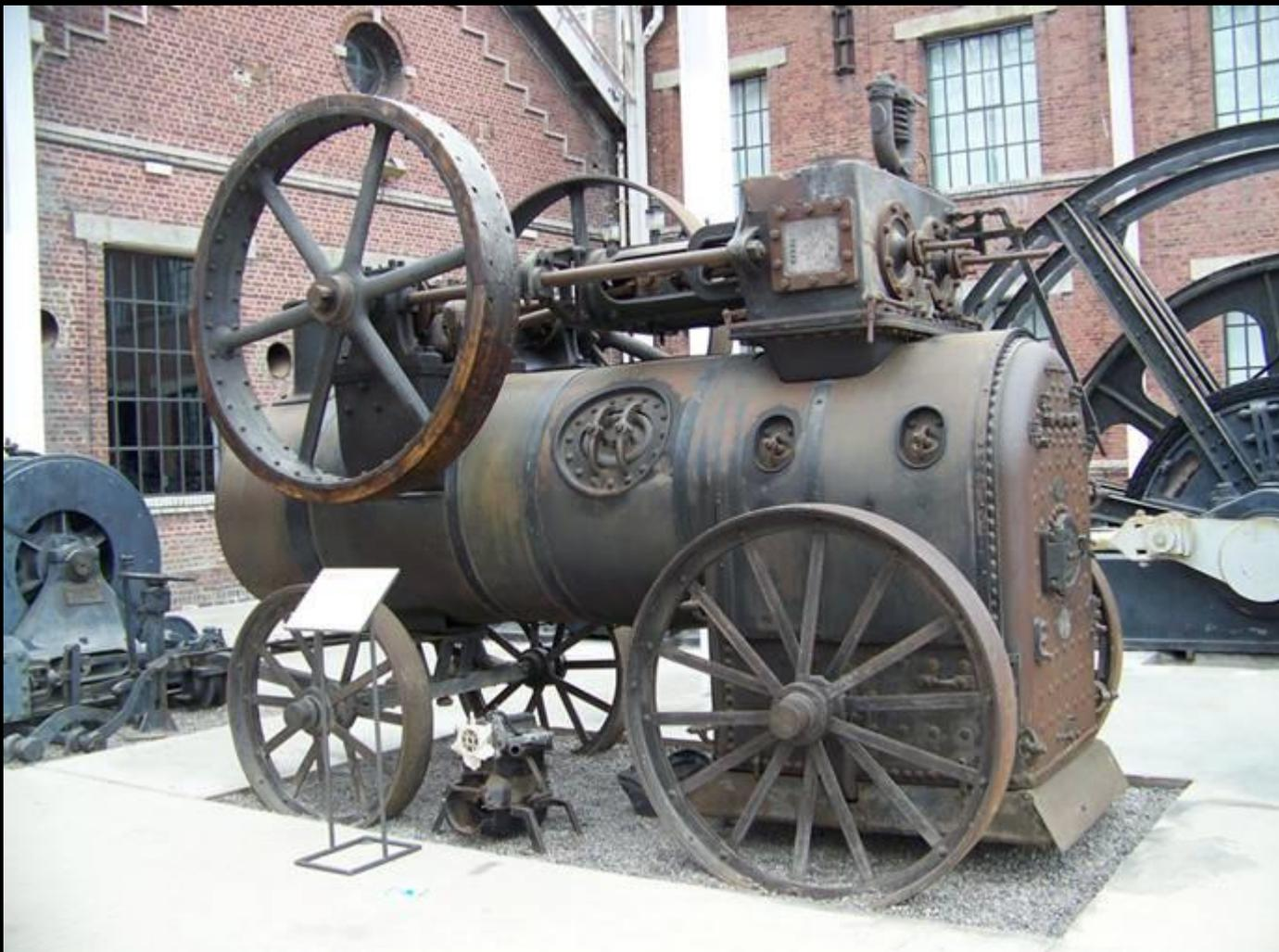
**Cette machine à vapeur faisait tourner un compresseur pour envoyer de l'air dans les galeries. Avec 2,5 m de haut et ses 3 de long, elle fournissait une puissance équivalente à celle d'une voiture Renault 4L.**
