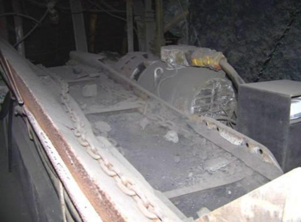
Tapis roulant permettant de transporter le charbon par vibrations. On nous l'a fait tourner, quel bruit...
